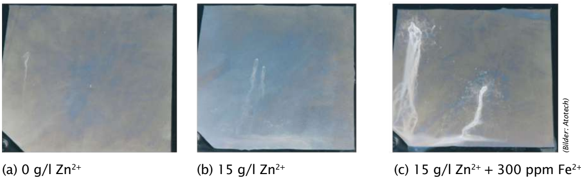
Abb. 12: Einfluss der Metallionenverunreinigung (Zink und Eisen) auf den Korrosionsschutz, 192 h NSS, ISO 9227
