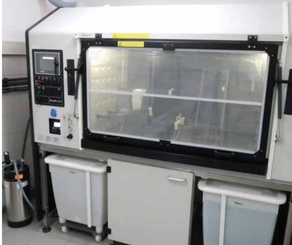
Prüfkammer für die Tests ACT I und ACT II von Volvo sowie L00-467 von Ford
