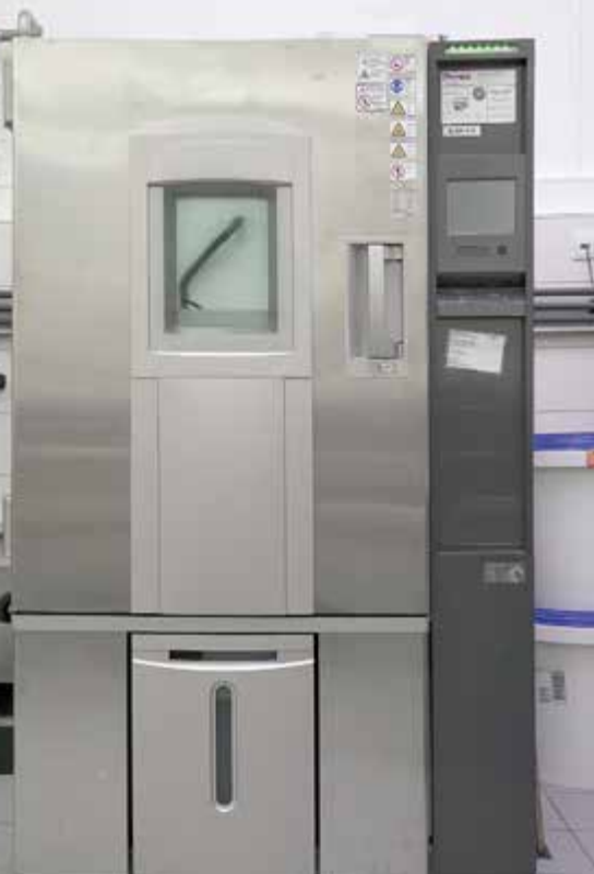
Prüfkammer für den Kondensklimatest gemäß DIN EN ISO 6270-2
