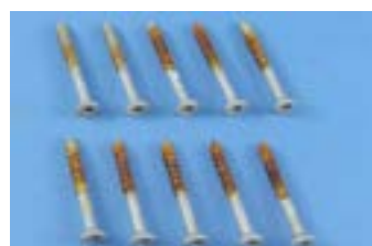
Abb 23b: Zinkphosphat + 2 x Topcoat Silber
