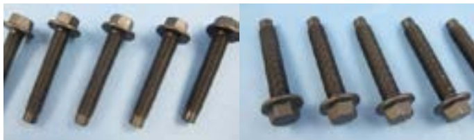
Abb. 14: Zink-Nickel-Oberfläche mit Schwarzpassivierung und 8 µm dicker schwarzer Topcoat-Schicht, 240 h EN ISO 9227 (li.), 1.008 h EN ISO 9227 (re.)
