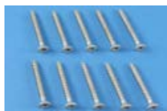
Abb. 23: Verschiedene Beschichtungssysteme nach zehn Zyklen Kesternichtest EN ISO 6988 2,0 S; 23a: Sauer Zink + Passivierung + 2 x Topcoat Silber
