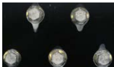
Abb. 21: Alkalisch Zink + Passivierung + reaktive Versiegelung, sechs Zyklen Ford-L-467-Test auf KTL
