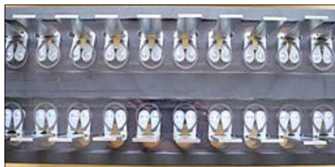
Abb. 11: Verwendeter Prüfstand für die Verspannversuche an C-Ring-Proben
