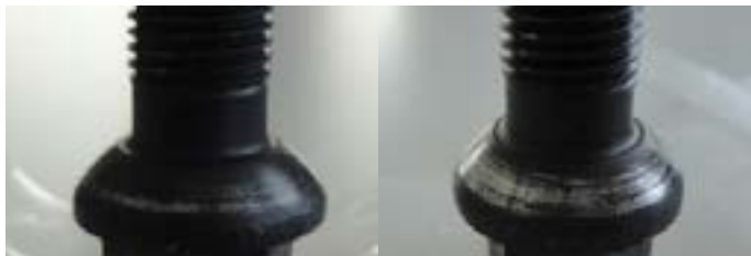
Abb. 13: Schraube nach 20-fachem Anzugs- und Lösevorgang, mit Schwarzpassivierung (l.), mit transparenter Dickschichtpassivierung (r.)
