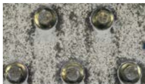
Abb. 20: Alkalisch Zink + Passivierung + reaktive Versiegelung, sechs Zyklen Ford-L-467-Test auf Aluminium
