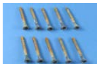
Abb 23c: Feuerverzinkt, acht Zyklen Kesternichtest
