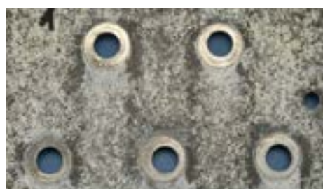
Abb. 22: Aluminium Kontaktstellen nach neun Zyklen Ford-L-467-Test. Beschichtung Schrauben: alkalisch Zink + Passivierung + reaktive Versiegelung
