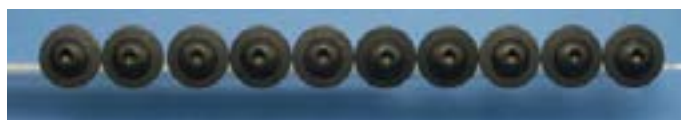
Abb. 16: ZnNi (12 µm) + Schwarzpassivierung + 1 x Topcoat (wasserbasiert, 30 min, 150 °C); 16a: 24 h NSST (ISO 9227)
