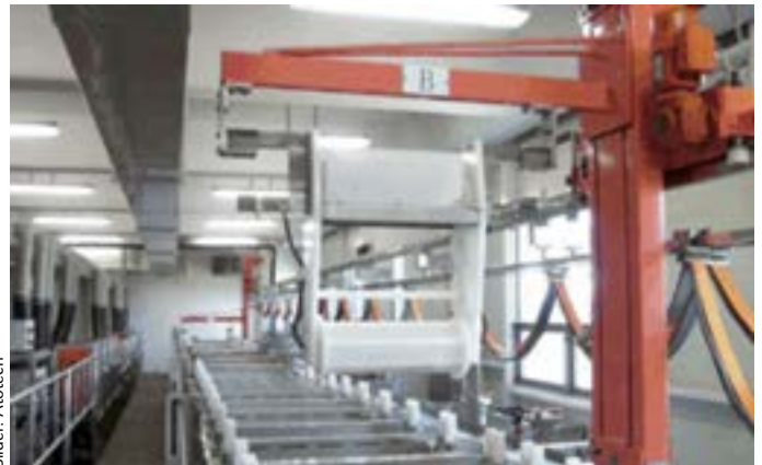
Abb. 1: Galvanische Beschichtungsanlage mit Trommel- (oben) und Gestellanlage (unten)
