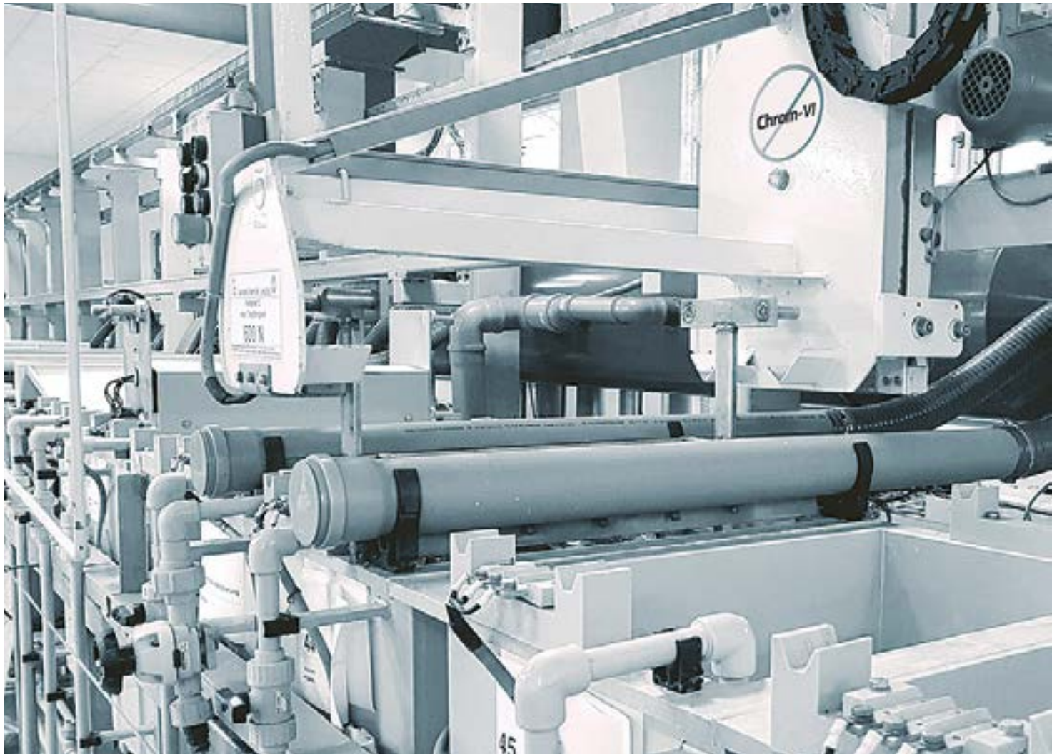
Chrom(VI)- und manganfreie automatisierte Anlage zur Beschichtung von ABS-Kunststoffen für Kleinserien nach dem Biconex-Verfahren
