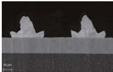
Abb. 2: REM-Aufnahme eines FIB-Schnitts von zwei Gold-Stud-Bumps auf einer verkupferten Keramikleiterplatte. Gold und Kupfer sollen jeweils durch Platin ersetzt werden.
