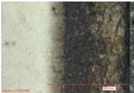
Gefüge einer nitrierten Randzone
