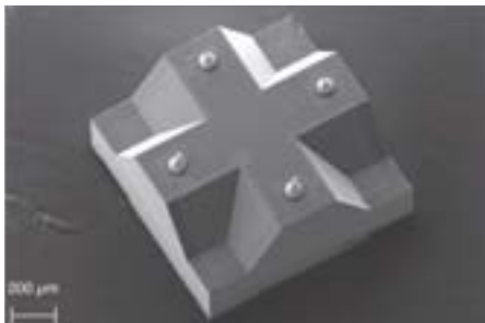
Abb. 1: REM-Aufnahme eines barometrischen Drucksensors mit Gold-Stud-Bumps. Das Goldsystem soll durch Platin ersetzt werden.
