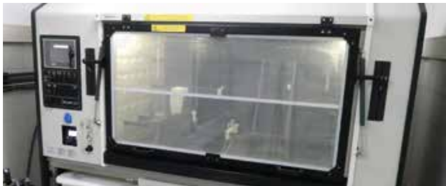
Prüfkammer für die Tests ACT I und ACT II von Volvo sowie L00-467 von Ford
