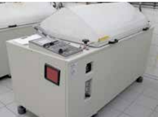
Prüfkammer für den Salzsprühnebeltest gemäß DIN EN ISO 9227
