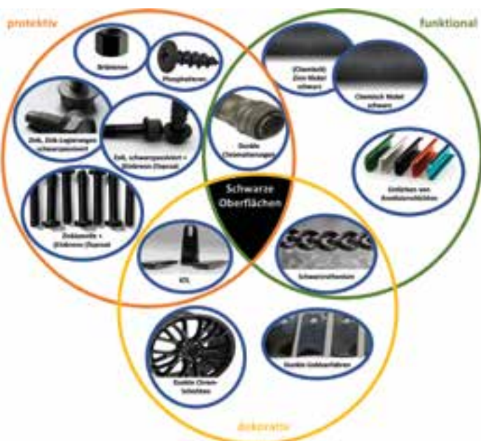
Abb. 1: Beispiele für die Erzeugung schwarzer Oberflächen für verschiedene Anwendungszwecke
