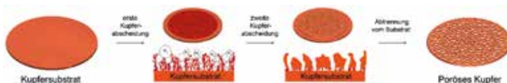
Abb. 1: Schematische Darstellung der galvanischen Abscheidung einer porösen Kupferschicht
