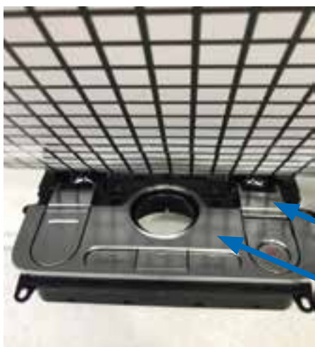
Abb. 1: Baugruppe einer Schaltermulde mit Bauteilen unterschiedlichen Glanzgrades
