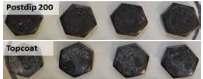
Abb. 8: Mit Postdip 200 nachbehandeltes Bauteil (oben), Schraubenköpfe nach 264 Stunden Salzsprühnebeltest (unten)
