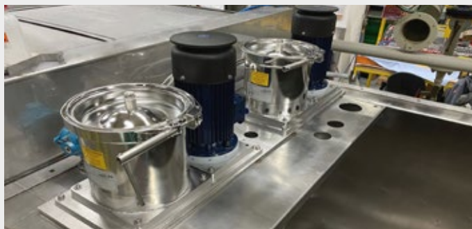
RENNER Tauchpumpen-Filter-Kombination beim Einsatz in einer Chemisch-Nickel-Anlage
