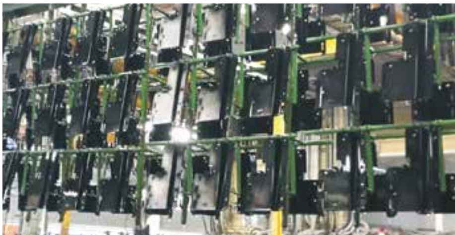
Abb. 17: Ungleichmäßige Ausbildung der Passivierungsschicht aufgrund indifferenter Badbewegung
