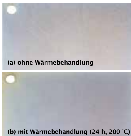
Abb. 6: Keine optische Veränderung der passivierten Oberfläche bei nachträglicher Wärmebehandlung
