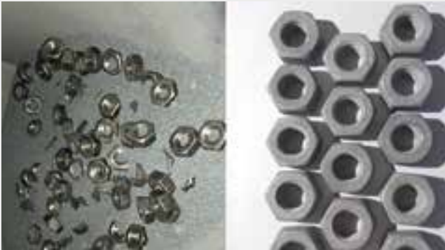
Bauteile mit Zinkpulvergemisch vor dem Prozess (links), Bauteile nach dem ZTD-Prozess (rechts)
