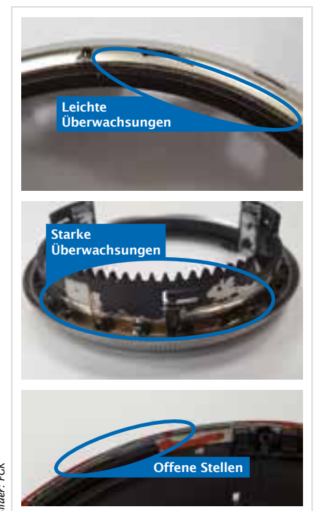
Abb. 2: Fehlerbilder im Anlieferzustand an Mehrkomponententeilen
