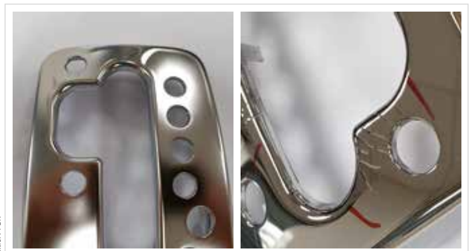
Abb. 6: Fehlerbilder an Teil #4 - Schaltabdeckung
