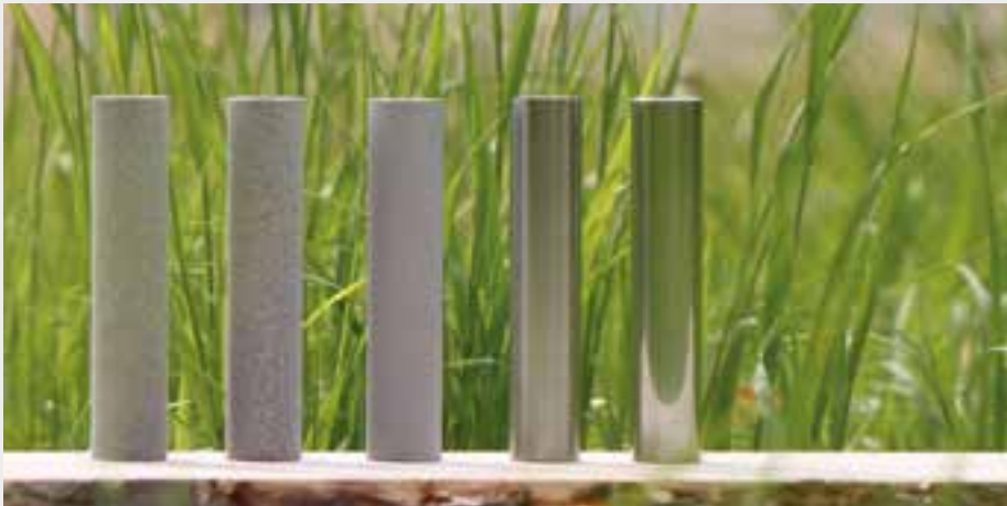
Bolzen mit verschiedenen Oberflächengüten mit BeGreen Chrome beschichtet
