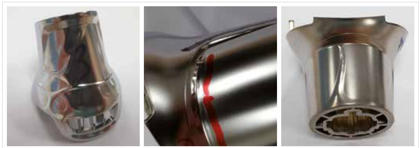
Abb. 5: Fehlerbilder an Teil #1 - Zierhülse AU 370
