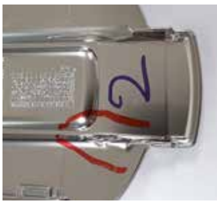
Abb. 7: Fehlerbilder an Teil #5 - Tankklappe
