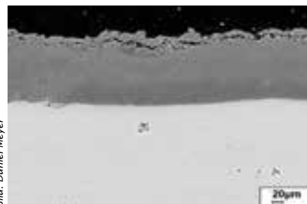
Querschliff einer PEO-Schicht auf Aluminium
