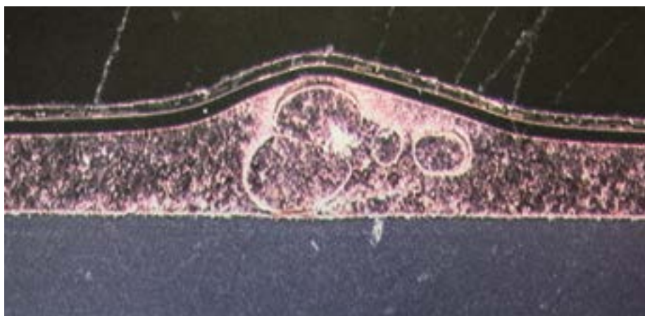
Abb. 4: Fehllackierung auf mikrobiellem Bewuchs
