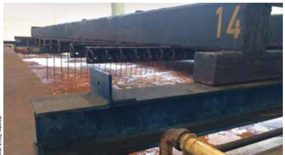
Abb. 5: Biologisch aktives Entfettungsspülbad für eine abwasserfreie Produktion
