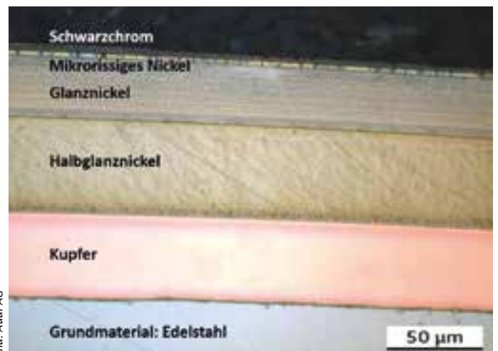
Schichtaufbau einer schwarzverchromten Endrohrblende
