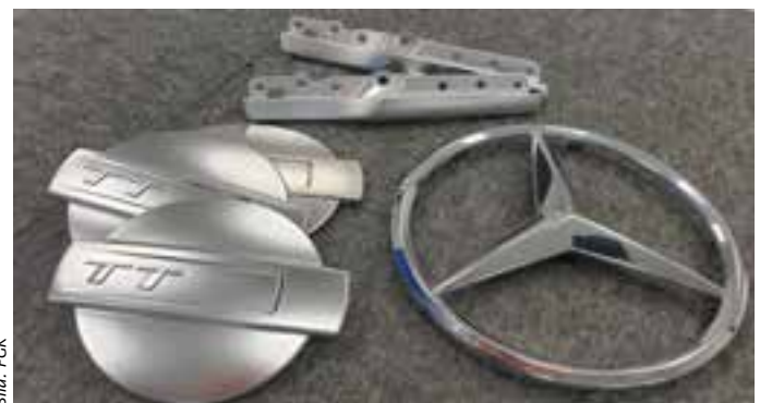
Kunststoffteile müssen bei der Galvanisierung vorbehandelt werden, damit die Metallschicht auf dem Substrat haftet.
