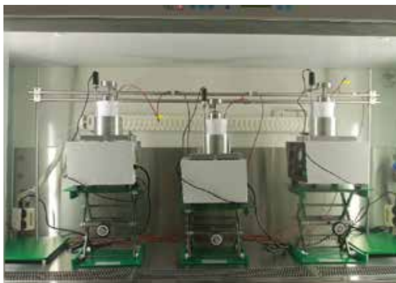
Abb. 1: links: Darstellung des Probenkörpers und des Elutionsversuchs, 100 cm 2 Oberfläche stehen im Kontakt mit 110 ml Elutionslösung; oben: Anordnung des Elutionsversuchs: drei Prüfkörper hängend in PTFE-Elutionsgefäßen auf Rühr-/Heizplatten mit zusätzlicher Heizmanschette
