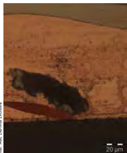
Abb. 4+5: Querschliff durch Beschichtungsfehler
