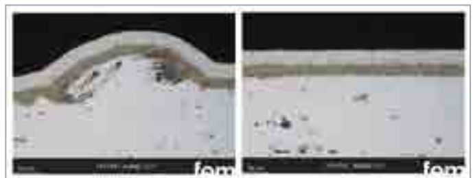
Abb. 2: Querschliffaufnahme einer beschichteten Probe, Substrat AlMg 3 - Vorbehandlung Zinkat 1 - Schichtfolge Ni - Sn-Ag (links: Störstelle, rechts: Referenzbereich)
