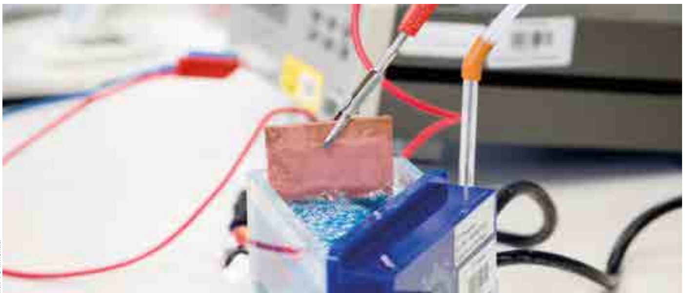
Kupferbeschichtung in der Hull-Zelle
