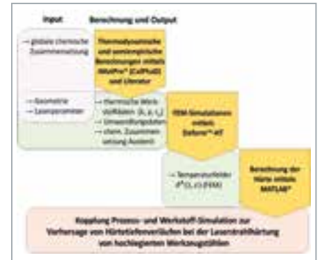
Abb. 2: Vorgehensweise zur Berechnung der Härtetiefenverläufe beim Laserstrahlhärten von hochlegierten Werkzeugstählen
