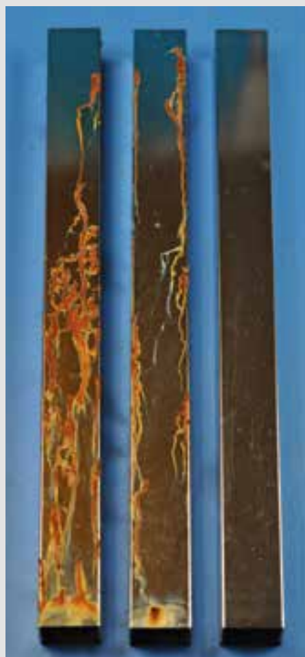
480-h-Salzsprühetest nach DIN EN ISO 9227 (v.l.): Bauteile Marktstandard, TRISTAR 330 AF, TRISTAR 330 AF + TRISTAR SHIELD
