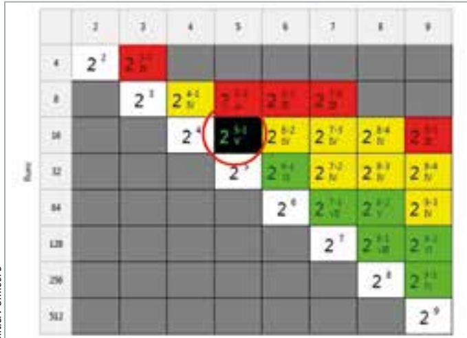
Abb. 1: Aufstellung der DoE entsprechend der Matrix aus Design-Expert
