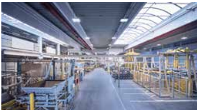
Abbildung 8: Trommelanlage zur ZnNi-Beschichtung mit integriertem Temperofen
