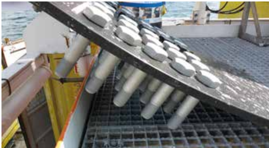
Auslagerungsversuch auf der Forschungsplattform FINO II in der Ostsee
