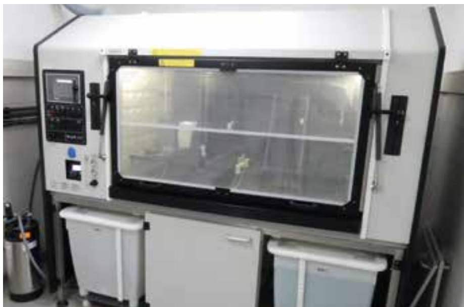
Prüfkammer für die Tests ACT I und ACT II von Volvo sowie L00-467 von Ford
