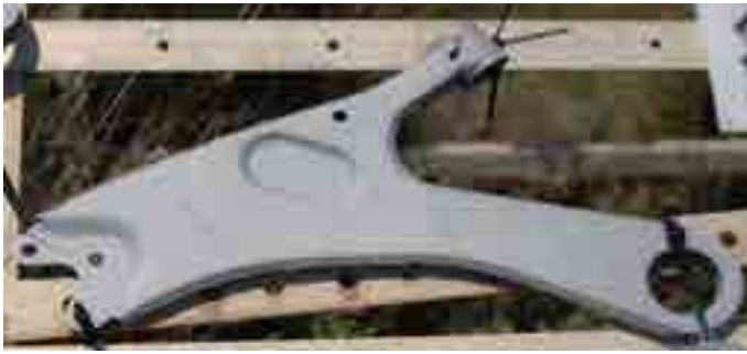
Querlenker in der Freibewitterung (maritimes Klima) nach 60 Monaten
