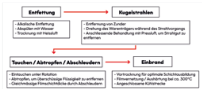
Prozessschritte des Gestell-Tauchschleuderverfahrens
