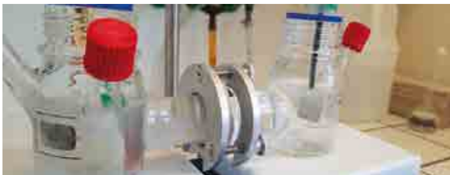
Elektrochemische H-Zelle für die Synthese der Gold(I)-Komplexe
