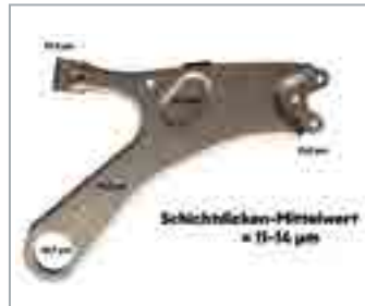
Querlenker aus dem Serienbetrieb mit GEOMET®-Schichtdickenverteilung
