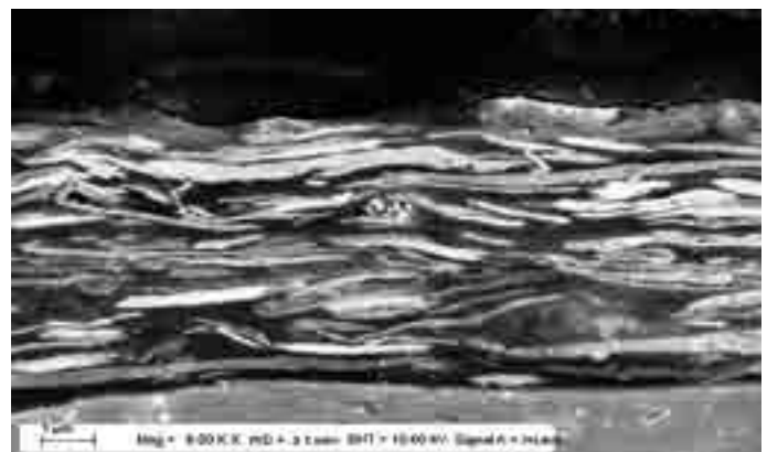
Querschnitt durch eine Zinklamellenschicht mit den sichtbaren Zink- und Aluminiumlamellen
