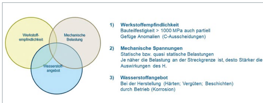
Abb. 2: Voraussetzungen für Wasserstoffversprödung
