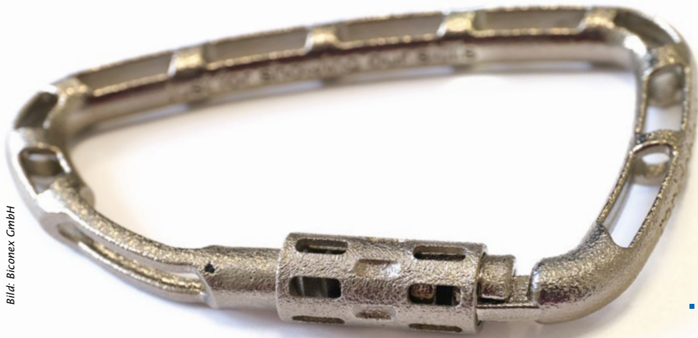
Abb. 4: MJF-Bauteil mit galvanischer Beschichtung (Kupfer/Nickel)
