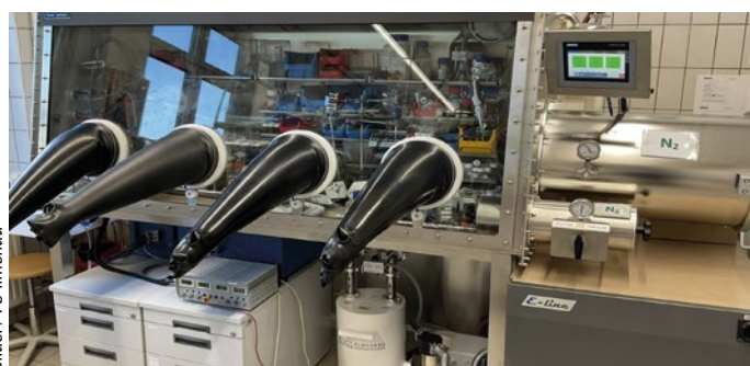
Abb. 1: Handschuhbox mit Stickstoffumgebung
