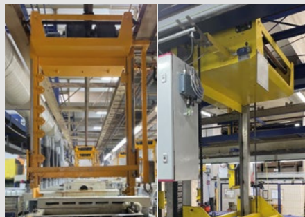
Anlage vor und nach Ausstattung mit HEHL-Steuerung/Schaltschrank
