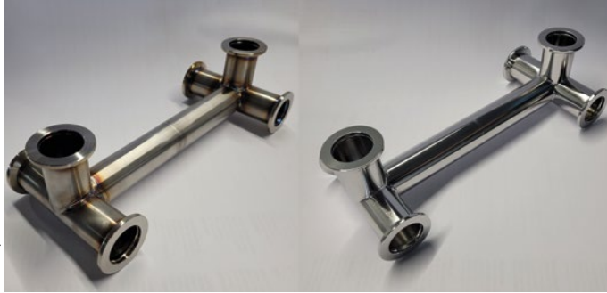
Abb. 2: Geschweißte Rohrbaugruppe links vor, rechts nach EPP/PEP
