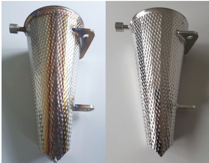
Abb. 3: Trichter für Schüttgüter der Lebensmittelindustrie links vor, rechts nach EPP/PEP
