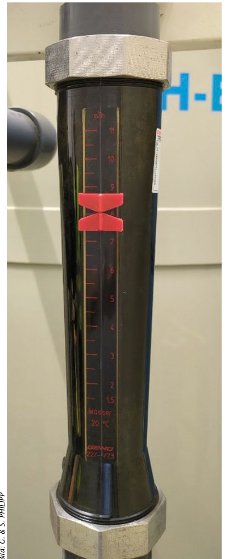
Durch Sulfid schwarz gefärbte Durchflussmesser
