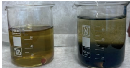
Abb. 2: Elektrolyte nach potentiometrischen Titrations zur Bestimmung der Stabilität der Eisen-Komplexe mit Citronensäure (l.) und Tetramethylammoniumchlorid (r.) bei pH 7. Die Ausfällung zu Hydroxiden im rechten Elektrolyten zeigt eine unzureichende Stabilität des Elektrolyten für die Anwendung in einer Fe-RFB an.
