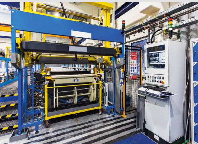
Automatisierte Galvanikanlage mit zentraler Prozesssteuerung
