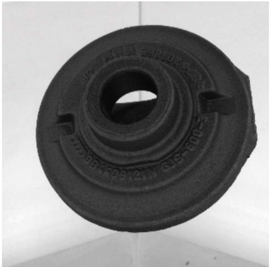
Abb. 2: Gussteil in einer Messkugel: Die gesamte Oberfläche wird frei fallend qualitätsgeprüft – dank gleichzeitiger Bildaufnahme von allen Seiten.
